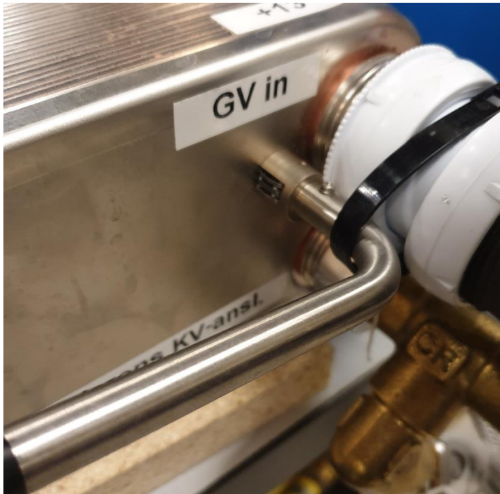
Figur 3. mätning av temperatur på värmeväxlarens yta.
